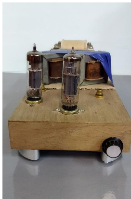
Фото 1, 2. Усилитель звуковой частоты на лампах «Студийный» класса А
