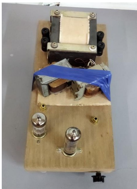
Фото 1, 2. Усилитель звуковой частоты на лампах «Студийный» класса А
